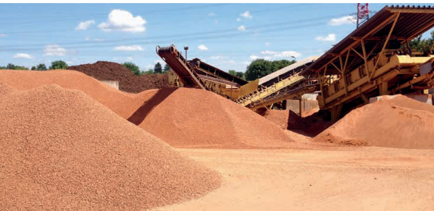
Herstellung rezyklierter Gesteinskörnungen zur Verwendung als Substrat im Vegetationsbau.
