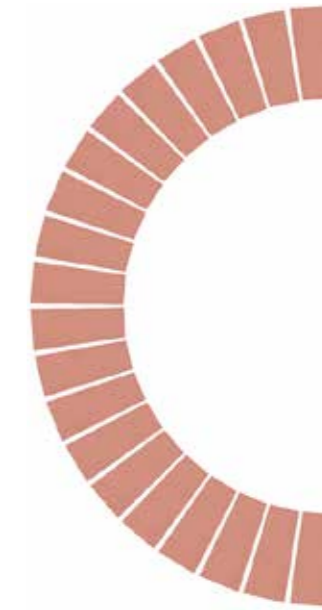
Abb. A5-7: Baumscheibe mit Keilklinkern
